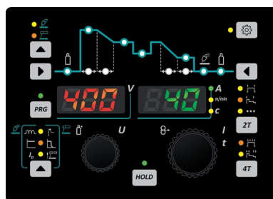
ПДГ 500.2 Панель интерфейса пользователя с расширенным функционалом
